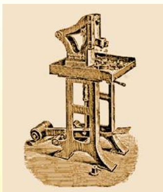
Presse à choc à pédale allemande pour porcelaine électrique (1905 La Céramique Industrielle, A. Granger, Musée Ultimheat).
