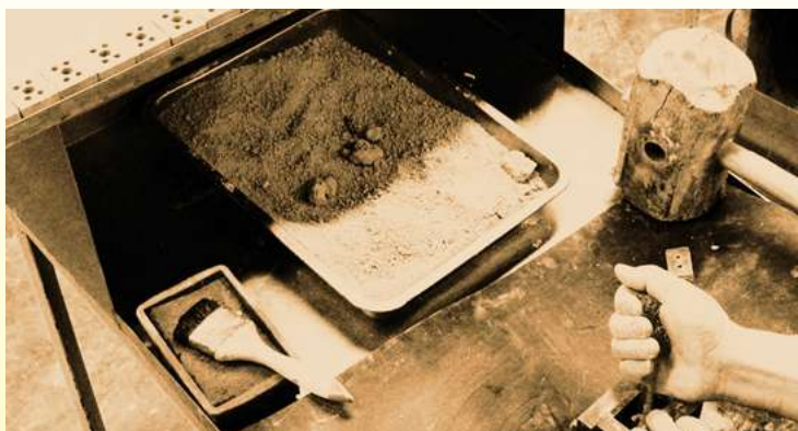
Borniers en porcelaine fabriqués manuellement par pressage au marteau : remplissage manuel du granulat humecté (Collection privée)
