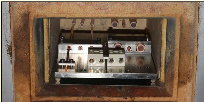
Four d'essai de la résistivité des céramiques en fonction de la température (Laboratoire Ultimheat)
