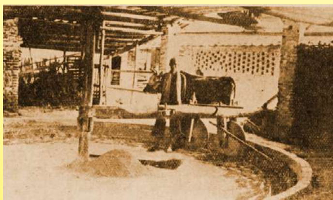
Broyage du kaolin par des meules actionnées par un boeuf (1939, Vietnam, Bulletin économique de l'Indo-Chine)
