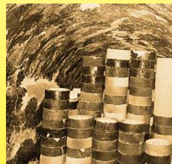
Four Dragon traditionnel chinois (龙窑 Long Yao), vue de la bouche d'alimentation et méthode de remplissage avec des porcelaines électriques (collection privée).
